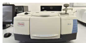
Spectroscopie Infrarouge à transformée de Fourier UV
