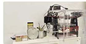
FDM 5 filaments- Multicouleurs
