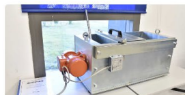
Maniabilimètre à béton
