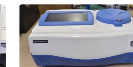
Pycnomètre : Mesure de densité
