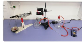
Détermination du coefficient adiabatique des gaz
