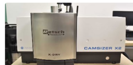
Imagerie morphologique (taille et forme des particules)
