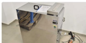
Bain thermostatique avec groupe réfrigéré
