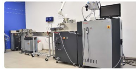
Extrudeuse et mélangeur batch
