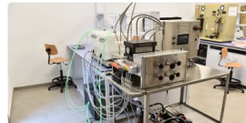
Banc de test des membranes d'osmose directe
