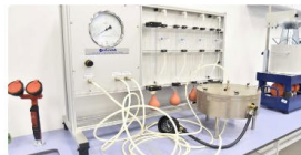
Mesure de la perméabilité à l'air
